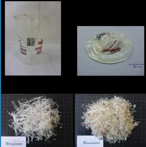
Durch einen zusätzlichen thermischen Behandlungsschritt in der mechanischen Recyclingkette, kann eine Umorientierung der Polymermoleküle und damit >10% Gesamtenergieeinsparung erreicht werden.
