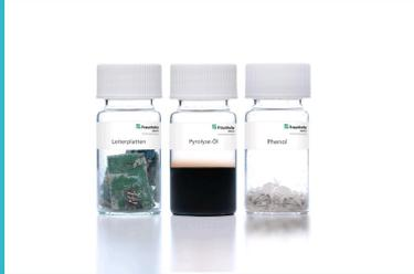
Wie können stark verunreinigte und problematische Kunststoffabfälle im Kreis geführt werden? Im CCPE®-Technikum wird ein thermochemisches Verfahren (Pyrolyse) zur Rückgewinnung von Grundchemikalien für das chemische Recycling qualifiziert. Ziel ist es, Kunststoffe in Neuwarequalität herzustellen.
