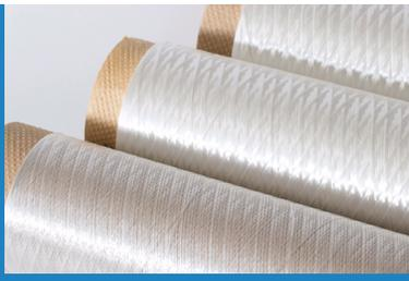
Am Markt verfügbar und biologisch abbaubar: Polymilchsäure (PLA) ist ein innovatives Polymer, das in Verpackungsmaterialien oder chirurgische Fäden Verwendung findet. CCPE®-Forschende arbeiten daran, technische Fasern auf Basis von Polymilchsäure für den Schmelzspinnprozess zu entwickeln – Basis für einen neuen Einkomponenten-Verbundwerkstoff.
